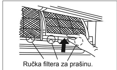
2. Držite ručku filtera za prašinu i podignite ga malo da ga izvadite iz držača filtera.
